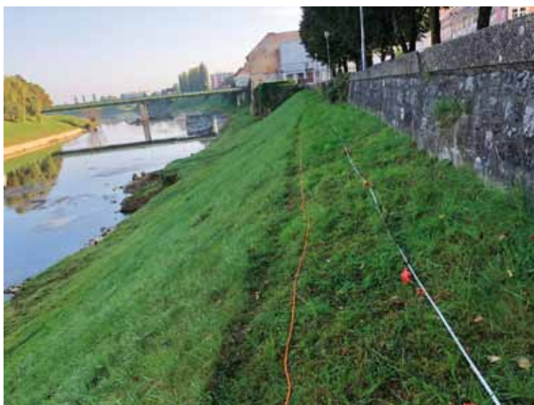
Ispitivanje infrastrukture u gradu Karlovcu: lijevo – geofizička nerazorna ispitivanja obaloutvrde; desno – oblak točaka dobiven primjenom bespilotnih letjelica i fotogrametrijske metode
