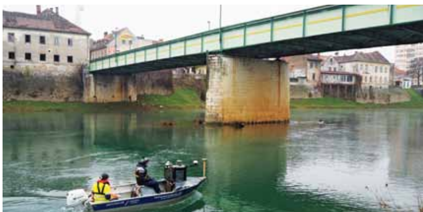
Ispitivanje infrastrukture u gradu Karlovcu: lijevo - batimetrijsko ispitivanje korita rijeke Kupe; desno - razvijeni 3D model Banijskog mosta na temelju oblaka točaka
